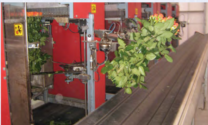
Lot homogène de dix tiges florales très longues, tenu par le bras articulé de l'automate calibreur
